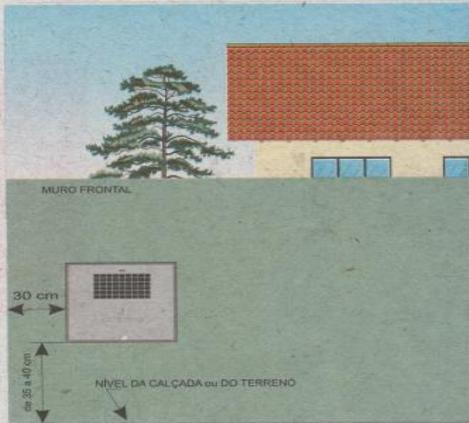
FIGURA 2 - INSTALAÇÃO FRONTAL COM MURETA
